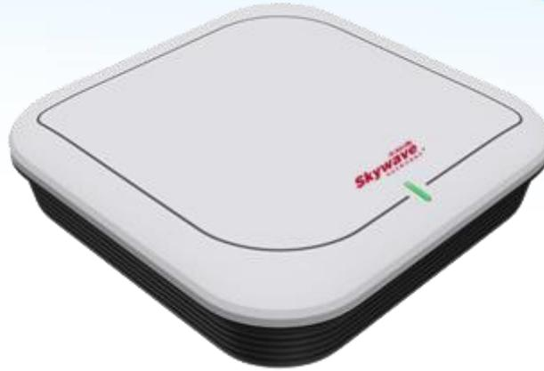
**Skywave** (天际通) UBS30-E 是一款室外/室内单基站高精定位基站, 采用 UWB-AOA 定位技术, 定位精度最高可达 10-30cm, 支持以太网接口网络连接, 支持标准 POE 或 DC12V 供电方式, 工作温度支持 -40°C ~ 70°C, IP67 一体化全封闭设计防尘防水, 支持吸顶安装/支架安装。
