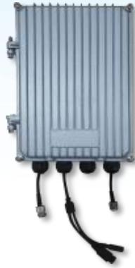
**Skywave** (天际通) UBS20-T 是一款隧道型高精定位基站, 采用 UWB-TDOA/TOF 定位技术, 定位精度最高可达 10-30cm, 支持以太网接口网络连接, 支持 DC12V 供电方式, 工作温度支持-40°C ~ 70°C, IP67 一体化全封闭设计防尘防水, 支持支架安装。
