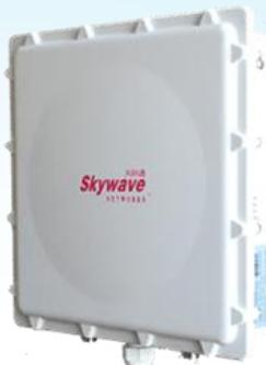
**Skywave** (天际通) SW8000-CT6330 是一款工业级无线漫游终端，工作在 5GHz 免许可频段，是一款符合 IEEE 802.11a/n 标准的无线网络设备，专为移动无线宽带网络通信而设计。产品基于 IEEE802.11n 的 MIMO (多进多出) 技术，采用 2T2R 构架，支持无线传输速率高达 300Mbps。支持在不同基站间的高速无缝漫游，先进的漫游算法和专门设计的自定义信号阈值功能，从而保证网络的正常通信和数据的传输。射频合并功率输出最高可达 2\*500mW，灵敏度高达-98dBm，设备采用 2\*N 型天线接口，可以根据现场的情况外接不同型号的天线，特别适用于物流仓储、智能制造、港口码头、轨道交通、电厂电网、金属冶炼、智慧矿山、综合管廊、驾培驾考、机械作业自动化、智能安保、AGV 机器人等各行业移动宽带通信的应用。
