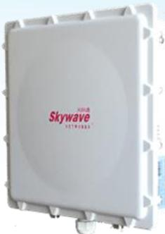
**Skywave** (天际通) SW8000-BS2300 是一款室外电信级无线漫游基站，工作在 2.4GHz 免许可频段，是一款符合 IEEE 802.11b/g/n 标准的无线网络设备，专为移动无线宽带网络通信而设计。产品基于 IEEE802.11n 的 MIMO (多进多出) 技术，采用 2T2R 构架，支持无线传输速率高达 300Mbps，射频功率合并输出最高可达 2\*500mW，灵敏度高达-98dBm。支持在不同基站间的高速无缝漫游，先进的漫游算法和专门设计的自定义信号阀值功能，配合专用无线控制器和无线车载终端，从而保证数据和视频的正常传输，真正做到无缝漫游、切换不丢包、数据上传不丢失、视频流畅。设备采用 2\*N 型射频接口，可以根据现场的情况外接不同型号的天线，特别适用于物流仓储、智能制造、港口码头、轨道交通、电厂电网、金属冶炼、智慧矿山、综合管廊、驾培驾考、机械作业自动化、智能安保、AGV 机器人等各行业移动宽带通信的应用。
