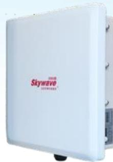
**Skywave** (天际通) SW8000-BV800-SFP 是一款室外电信级天线一体化无线基站，工作在 5GHz 免许可频段，是一款符合 IEEE802.11ac 标准的无线网络设备。产品采用高性能的高通 Atheros 高速网络处理器，基于 IEEE802.11ac 的 MIMO (多进多出) 技术，采用 2T2R 构架，支持无线传输速率高达 867Mbps。同时向下兼容 802.11a/n 标准，射频合并功率输出最高可达 2\*500mW，灵敏度高达 -98dBm，设备集成 2\*2MIMO 板状定向天线，特别适用于长距离骨干网传输工程及大数据流实时业务如油田、电力、水利、林业、工矿企业、平安城市、智能交通、数字化能源等高清视频监控应用。
