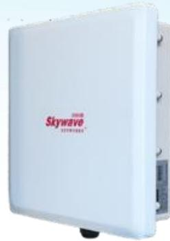
**Skywave** (天际通) SW8000-SU625 是一款室外电信级天线一体化无线网桥，工作在 5GHz 免许可频段，符合 IEEE802.11ac 标准的无线网络设备。产品采用高性能的高通 Atheros 高速网络处理器，基于 IEEE802.11ac 的 MIMO (多进多出) 技术，采用 2T2R 构架，支持无线传输速率高达 867Mbps，同时向下兼容 802.11a/n 标准，射频合并功率输出最高可达 2\*400mW，灵敏度高达 -98dBm，设备集成 2\*2MIMO 板状定向天线，特别适用于长距离骨干网传输工程及大数据流实时业务如油田、电力、水利、林业、工矿企业、平安城市、智能交通、数字化能源等高清视频监控应用。
