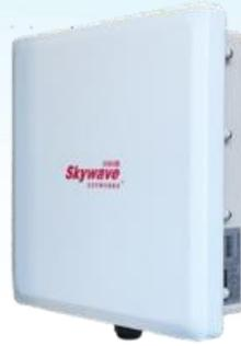
**Skywave** (天际通) SW8000-SU600 是一款室外电信级天线一体化无线网桥，工作在 5GHz 免许可频段，符合 IEEE802.11ac 标准的无线网络设备。产品采用高性能的高通 Atheros 高速网络处理器，基于 IEEE802.11ac 的 MIMO (多进多出) 技术，采用 2T2R 构架，支持无线传输速率高达 867Mbps，同时向下兼容 802.11a/n 标准，射频合并功率输出最高可达 2\*400mW，灵敏度高达 -98dBm，设备集成 2\*2MIMO 板状定向天线，特别适用于长距离骨干网传输工程及大数据流实时业务如油田、电力、水利、林业、工矿企业、平安城市、智能交通、数字化能源等高清视频监控应用。
