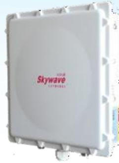
**Skywave** (天际通) SW8000-S3026 是一款室外电信级分体无线网桥，工作在 5GHz 免许可频段，符合 IEEE802.11a/n 标准的无线网络设备。产品采用高性能的高通Atheros 高速网络处理器，基于 IEEE802.11a/n 的 MIMO (多进多出) 技术，采用 2T2R 构架，支持无线传输速率高达 300Mbps，射频合并功率输出最高可达 2\*200mW，灵敏度高达 -98dBm，设备采用 2\*N 型射频接口，可以根据现场的情况外接不同型号的天线，特别适用于长距离骨干网传输工程及大数据流实时业务如油田、电力、水利、林业、工矿企业、平安城市、智能交通、数字化能源等高清视频监控应用。
