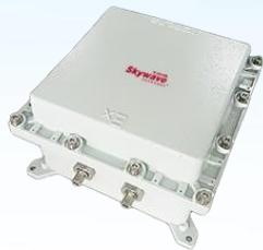
**Skywave** (天际通) SW8000EXD-B800 是一款防爆型室外电信级分体无线基站，工作在5GHz 免许可频段，是一款符合 IEEE802.11ac 标准的无线网络设备。产品采用高性能的高通Atheros 高速网络处理器，基于 IEEE802.11ac 的 MIMO (多进多出) 技术，采用 2T2R 构架，支持无线传输速率高达 867Mbps。同时向下兼容 802.11a/n 标准，射频合并功率输出最高可达 2\*500mW，灵敏度高达-98dBm，设备采用 2\*N 型射频接口，可以根据现场的情况外接不同型号的天线，特别适合化工、制药、石油化工及能源等行业的危险品生产、物流、仓储等环节，以及石油天然气开采平台、天然气储存场地、地下管廊等应用场合。
