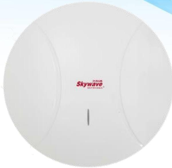
**Skywave** (天际通) UBS10-G 是一款室内高精定位基站，采用 UWB-TDOA/TOF 定位技术，定位精度最高可达 10-30cm，支持 4G 网络连接，支持标准 POE 或 DC12V 供电方式，工作温度支持 40°C ~ 70°C，支持支架安装。
