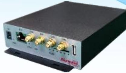
**Skywave** (天际通) SW8000-CT7100 是一款工业级无线漫游终端，工作在双路 2.4GHz/5GHz 免许可频段，是一款符合 IEEE 802.11a/b/g/n 标准的无线网络设备，专为移动无线宽带网络通信而设计。产品基于 IEEE802.11n 的 MIMO (多进多出) 技术，采用 4T4R 构架，支持无线传输速率高达 600Mbps。支持在不同基站间的高速无缝漫游，先进的漫游算法和专门设计的自定义信号阈值功能，从而保证网络的正常通信和数据的传输。射频合并功率输出最高可达 4\*500mW，灵敏度高达 -98dBm，设备集成 4\*SMA-K 天线接口，可以根据现场的情况外接不同型号的天线，特别适用于物流仓储、智能制造、港口码头、轨道交通、电厂电网、金属冶炼、智慧矿山、综合管廊、驾培驾考、机械作业自动化、智能安保、AGV 机器人等各行业移动宽带通信的应用。
