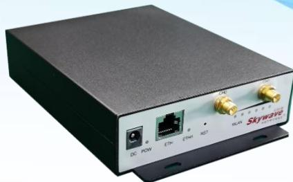
**Skywave** (天际通) SW8000-CT5829 是一款工业级移动漫游无线终端，工作在 5GHz 免许可频段，是一款符合 IEEE802.11ac 标准的无线网络设备，专为移动无线宽带网络通信而设计。产品基于 IEEE802.11ac 的 MIMO (多进多出) 技术，采用 2T2R 构架，支持无线传输速率高达 867Mbps，同时向下兼容 802.11a/n 标准。支持在不同基站间的高速无缝漫游，先进的漫游算法和专门设计的自定义信号阀值功能，从而保证网络的正常通信和数据的传输。射频功率输出单通道最高可达 2\*400mW，灵敏度高达-98dBm，设备集成 2\*SMA-K 天线接口，可以根据现场的情况外接不同型号的天线，特别适用于物流仓储、智能制造、港口码头、轨道交通、电厂电网、金属冶炼、智慧矿山、综合管廊、驾培驾考、机械作业自动化、智能安保、AGV 机器人等各行业移动宽带通信的应用。
