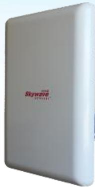
**Skywave** (天际通) SW8000-BSU6300 是一款室外电信级无线漫游基站, 工作在 5GHz 免许可频段, 是一款符合 IEEE802.11n 标准的无线网络设备, 专为移动无线宽带网络通信而设计。产品基于 IEEE802.11n 的 MIMO (多进多出) 技术, 采用 2T2R 构架, 支持无线传输速率高达 300Mbps, 同时向下兼容 802.11a 标准, 射频功率合并输出最高可达 2\*500mW, 灵敏度高达 -98dBm。支持在不同基站间的高速无缝漫游, 先进的漫游算法和专门设计的自定义信号阈值功能, 配合专用无线控制器和无线车载终端, 从而保证数据和视频的正常传输, 真正做到无缝漫游、切换不丢包、数据上传不丢失、视频流畅。设备集成 90 度双极化扇区天线, 特别适用于物流仓储、智能制造、港口码头、轨道交通、电厂电网、金属冶炼、智慧矿山、综合管廊、驾培驾考、机械作业自动化、智能安保、AGV 机器人等各行业移动宽带通信的应用。
