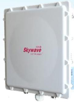
**Skywave** (天际通) SW8000-BS6300 是一款室外电信级无线漫游基站, 工作在 5GHz 免许可频段, 是一款符合 IEEE802.11n 标准的无线网络设备, 专为移动无线宽带网络通信而设计。产品基于 IEEE802.11n 的 MIMO (多进多出) 技术, 采用 2T2R 构架, 支持无线传输速率高达 300Mbps, 同时向下兼容 802.11a 标准, 射频功率合并输出最高可达 2\*500mW, 灵敏度高达 -98dBm。支持在不同基站间的高速无缝漫游, 先进的漫游算法和专门设计的自定义信号阈值功能, 配合专用无线控制器和无线车载终端, 从而保证数据和视频的正常传输, 真正做到无缝漫游、切换不丢包、数据上传不丢失、视频流畅。设备集成 2\*N 型射频接口, 可以根据现场的情况外接不同型号的天线, 特别适用于物流仓储、智能制造、港口码头、轨道交通、电厂电网、金属冶炼、智慧矿山、综合管廊、驾培驾考、机械作业自动化、智能安保、AGV 机器人等各行业移动宽带通信的应用。
